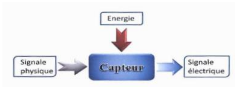
Figure II.14 : Fonctionnement du capteur
