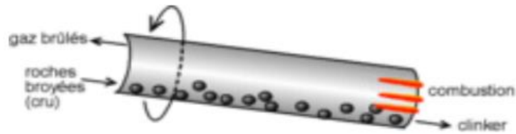
Figure II.11 : Circulation des gaz dans le four
