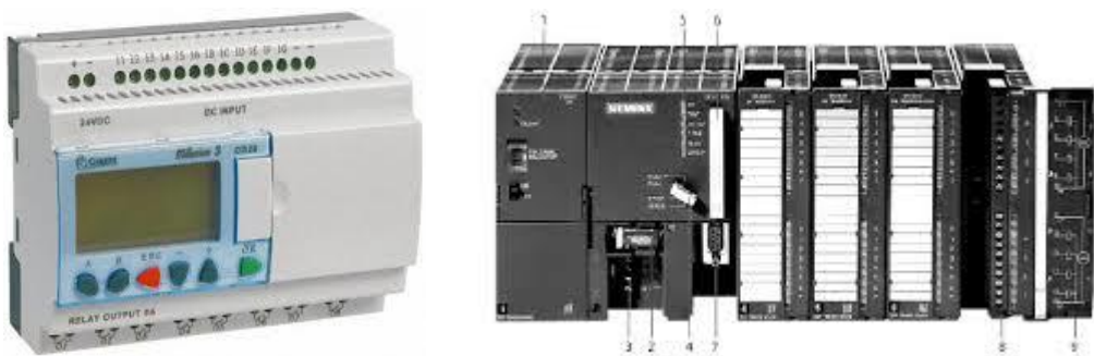
Figure 7.2: Automate de type compact\Automate de type modulaire
