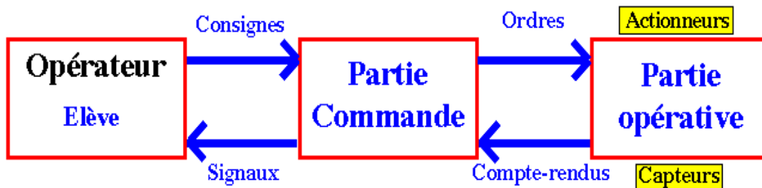
Figure 1.2 : présentation des différentes parties d'un système automatisé
