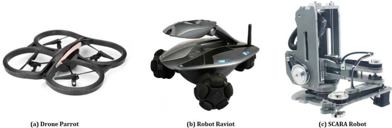
Figure III.1 : (a) Drone PARROT avec moteur brushless, (b) Robot Raviot avec MCC, (c) SCARA Robot avec moteur pas à pas.
