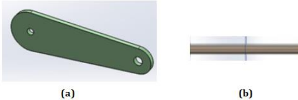
Figure II.17 : (a) Le bras du servo moteur, (b) La tige.
