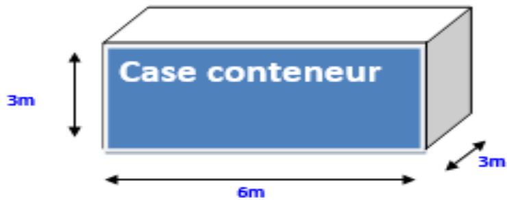
Figure 67 : case conteneur 20 pieds à l'intérieur du système.
