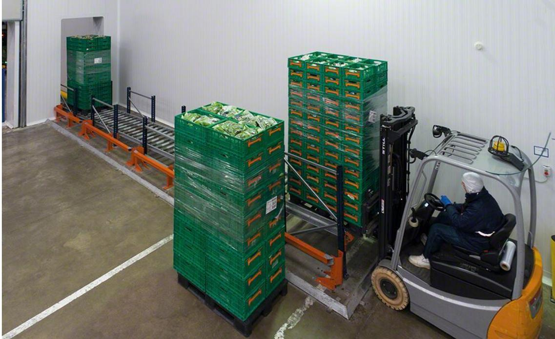
Figure 2.6 Chariots à mât rétractable pour déplacer les palettes sous l'effet de la gravité
