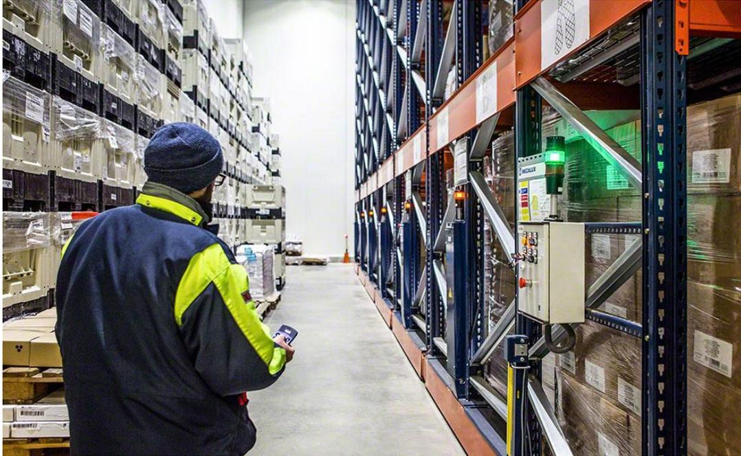
Figure 2.12 Solution Movirack (système de stockage par accumulation avec une capacité de 1 103 palettes.
