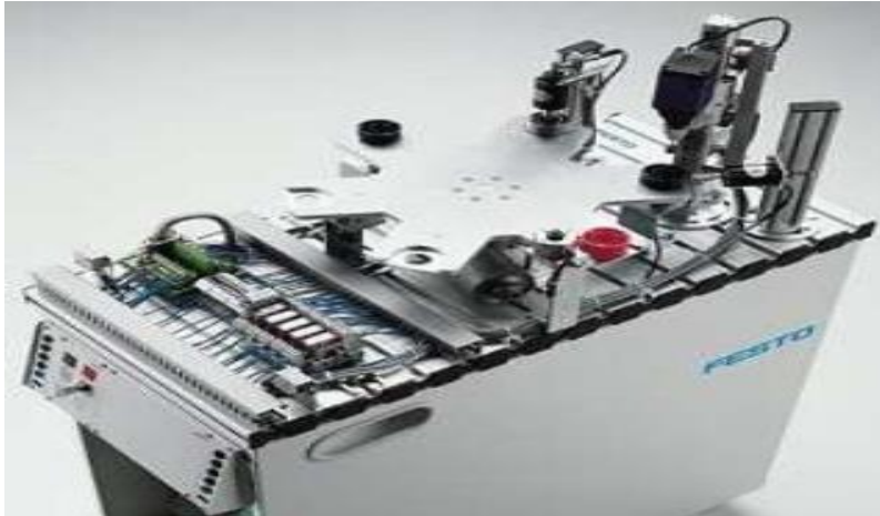
Figure II-7 La sous station d'usinage.
