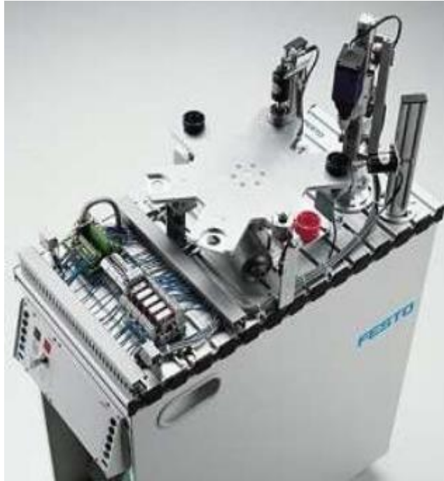
Figure I -34 La sous station d'usinage
