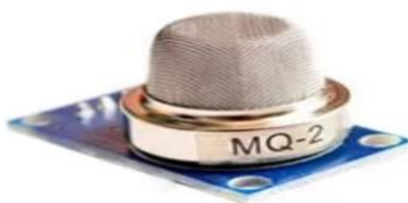
Figure I -15 Capteur de fumée
