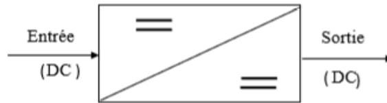
FIGURE 2.2 – Symbole d'un Hacheur [3]
